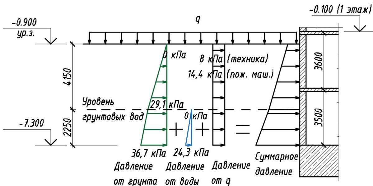
Расчет нагрузки от давления воды на фундаментную плиту снизу (дополнение к загрузению №15)
