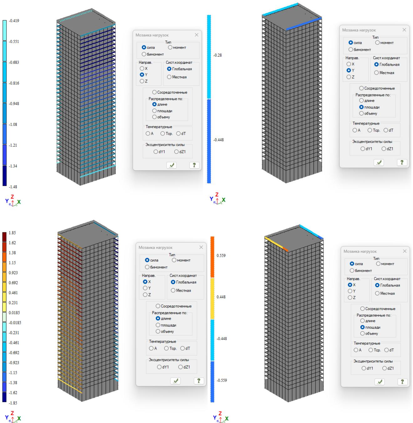
Рисунок. Загрузка 20. Ветровые нагрузки.
