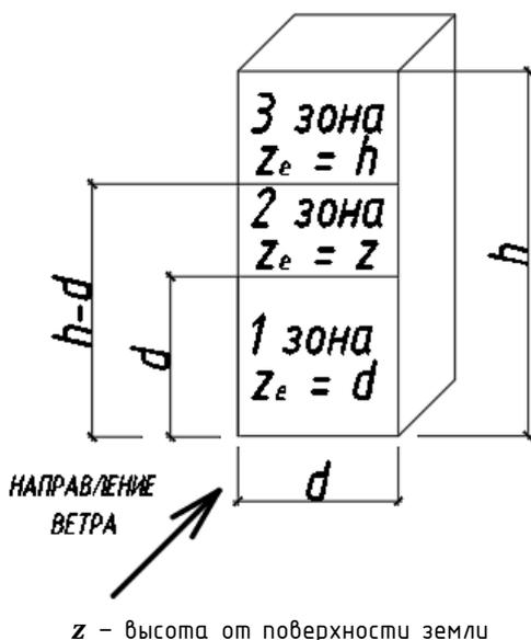
Расчет нагрузок при направлении ветра вдоль оси X
