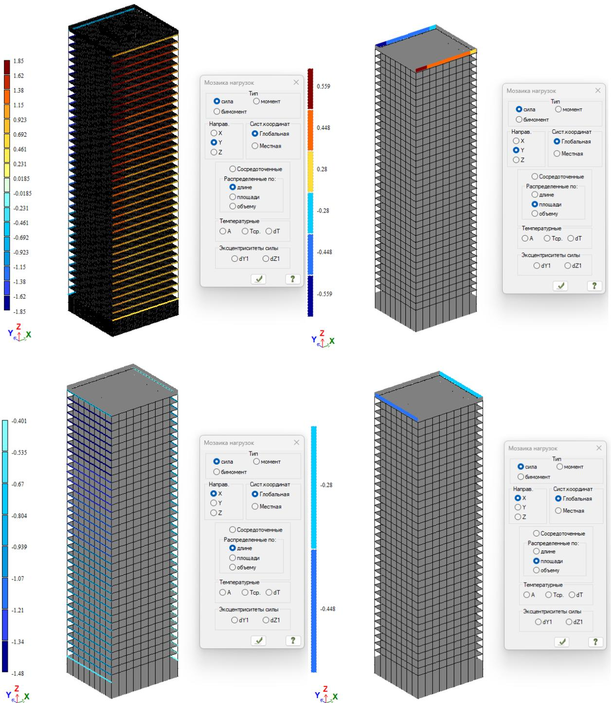
Рисунок. Загрузка 18. Ветровые нагрузки.
