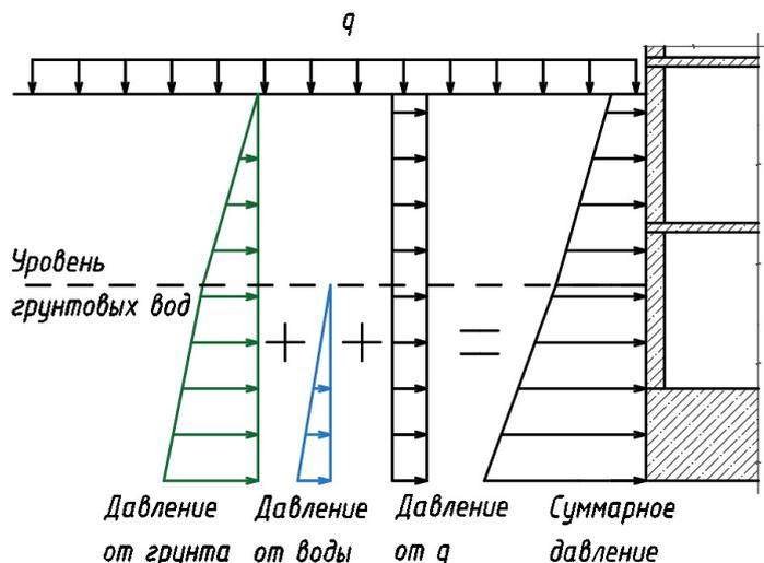
Справочная таблица №19. Вычисление грунтового давления для нескольких слоев
