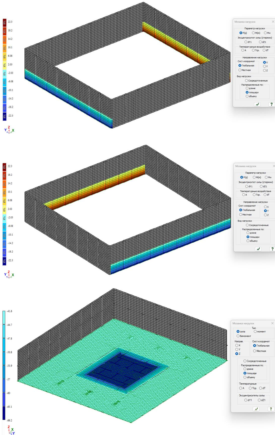
Рисунок. Давление от воды. Загрузка 15.
