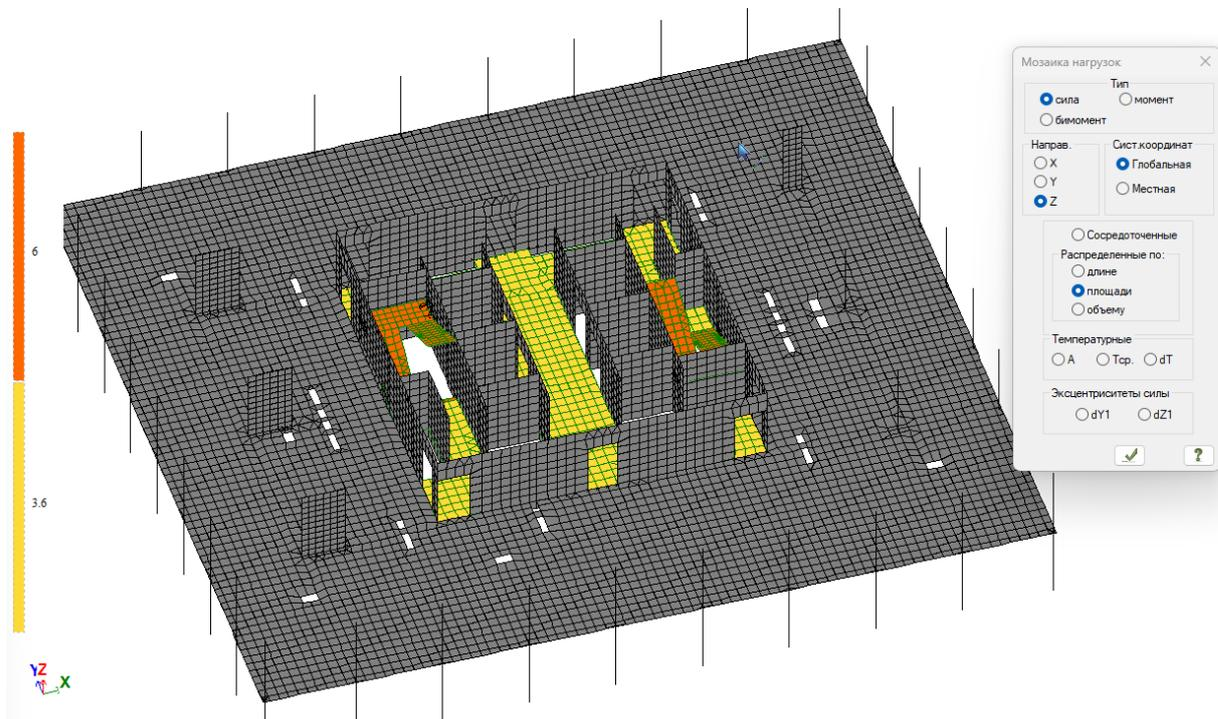
Рисунок. Коридоры и лестницы (типовой этаж). Загрузка 8.
