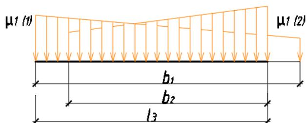
Если  $b_3 > b_1$  (и/или  $b_3 > b_2$ ), то принимается отдельно огибающая полученных эпюр  $\mu_{1(1)}$  и  $\mu_{1(2)}$ .
