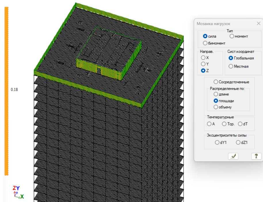
Рисунок. Нагрузки от фасадов по площади. Загружение 6.
