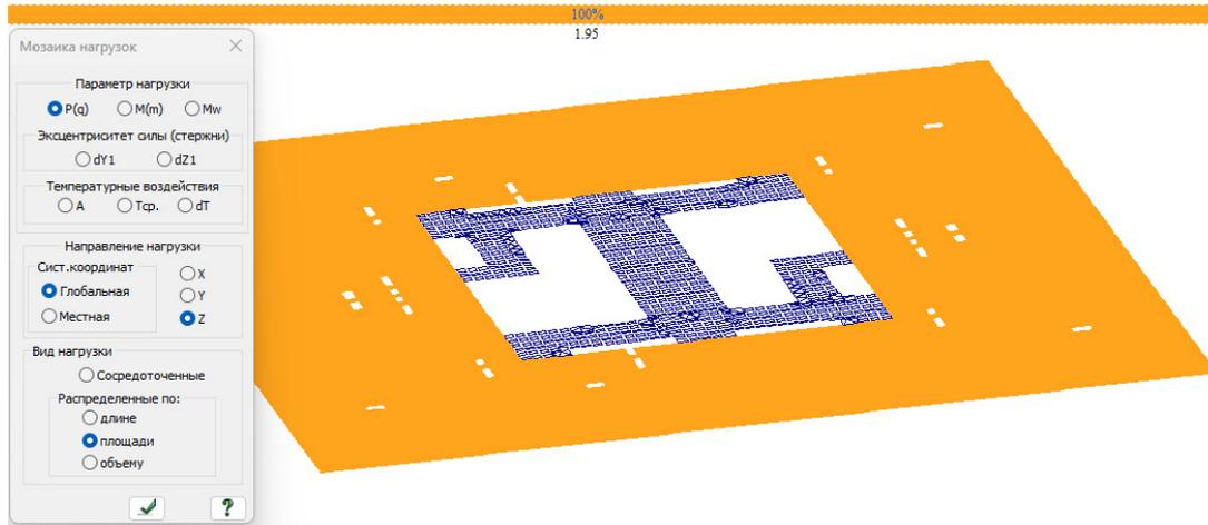
Присвоение свойств динамики пульсационной составляющей ветровой нагрузке
