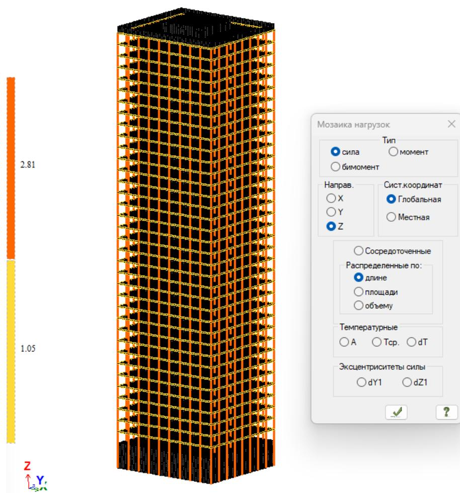
Рисунок. Нагрузка от отделки на линейные элементы. Загружение 5.
