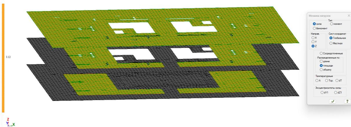
Рисунок. Нагрузки от перегородок на 1 этаже и в подвале. Распределенная нагрузка.
